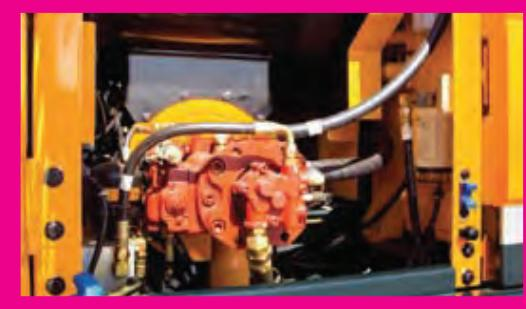
Для достижения оптимальной точности компания Hyundai переработала конструкцию гидравлической системы, обеспечив оператора возможностями сверхточного касания и улучшенной управляемости. Улучшенное управление подачей насоса уменьшает подачу, когда органы управления не используются, что позволяет свести к минимуму расход топлива.
