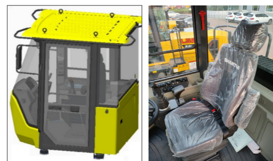
Стандартное сиденье на воздушной подушке с электронным управлением
