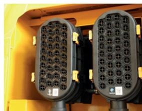
Прямочные параллельные воздушные фильтры удаляют 99,9% пыли, позволяя работать даже в сильно запыленной среде. Увеличенные сроки их обслуживания обеспечивают сокращение сервисных затрат.
