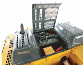
Капот опирается на гидравлический амортизатор, что упрощает его открытие при высоком уровне безопасности работы под капотом.
