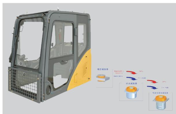
Кабина установлена на раме на амортизаторах, гасящих шум и вибрацию для обеспечения комфорта оператора. Стальная трубчатая рама по периметру кабины снизу увеличивает ее усталостную прочность и снижает уровень вибрации.
