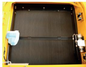
Автоматическая регулировка скорости вращения вентилятора системы распределенной смазки с возможностью его быстрого включения в обратном направлении упрощает очистку. Экскаватор может работать при высокой температуре и в тяжелых условиях.
