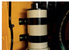
Топливные фильтры совершенной конструкции обеспечивают устойчивую работу двигателя при низких затратах на обслуживание. Единообразное расположение этих фильтров упрощает их разборку.
